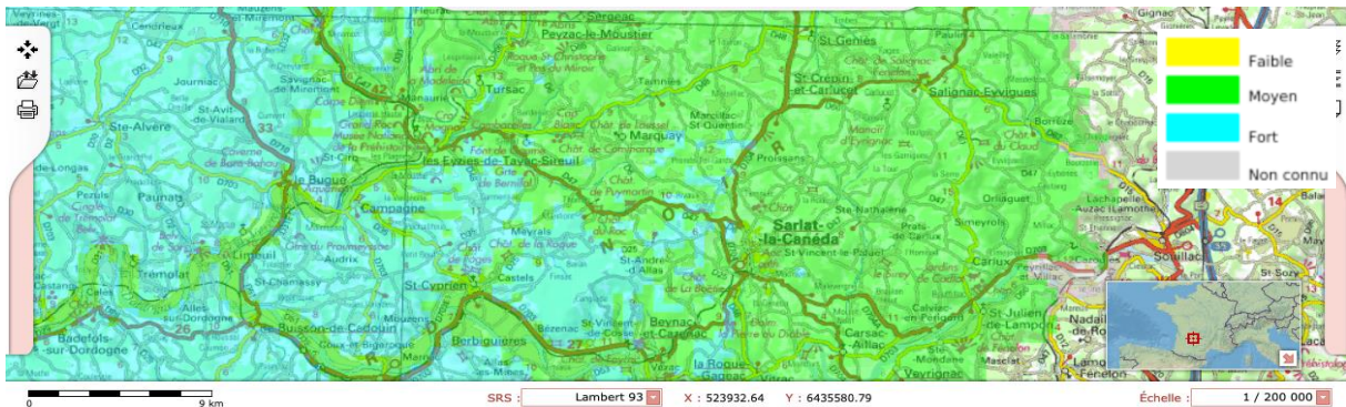
Figure 6 : Caractéristiques du meilleur aquifère en basse énergie (AQ) sur la partie Sud de la CCVH
